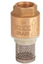
شیر یکطرفه فتری فیلتردار Inline Check Foot Valve Model: KIZZIRAN 516 Material: Brass Size: 1/2~2 inch W.P. : 1/2~1 inch 16 bar 1 1/4~2 inch 12 bar
